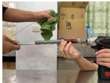
圖 4-5 用電動螺絲起子纏繞線圈
