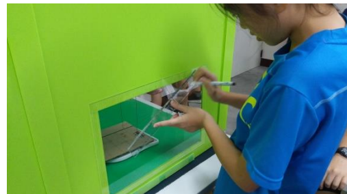
圖 17. 觀察窗畫上水平線及攻角度線
