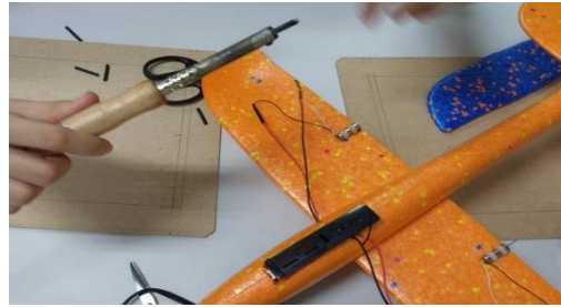
圖 26.將馬達與接收器連接置入槳
