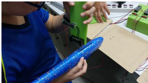
圖 23.挖取控制艙位
