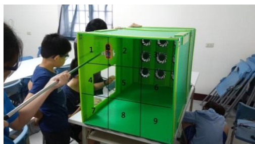
圖 15. 風洞機井字測量流速紀錄
