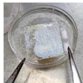
6. 將正極導電面朝上平置於桌面，滴上含有碘電解質的碘液，如圖 4-2-5。
