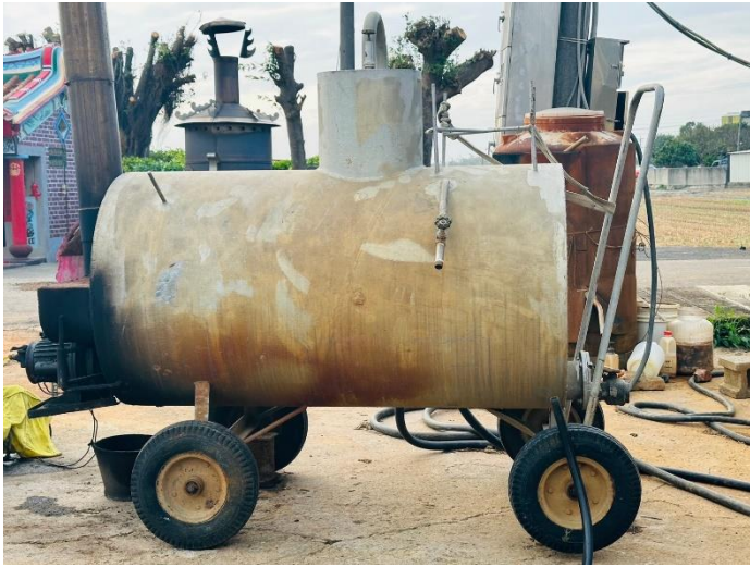
現代菇寮的機械-蒸氣發酵機
