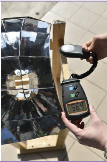
圖 28-1 陽光直接照射： 56400LUX 〈對照組〉
