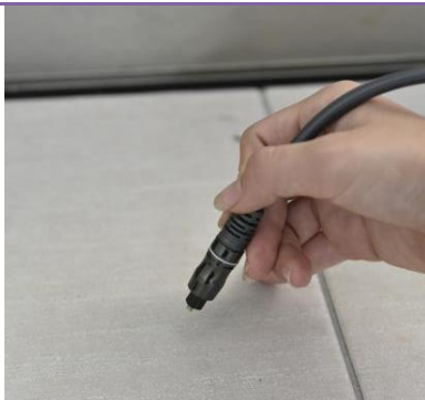
圖 29-1 陽光直接照射光纖： 只有微量光線滲出 〈對照組〉
