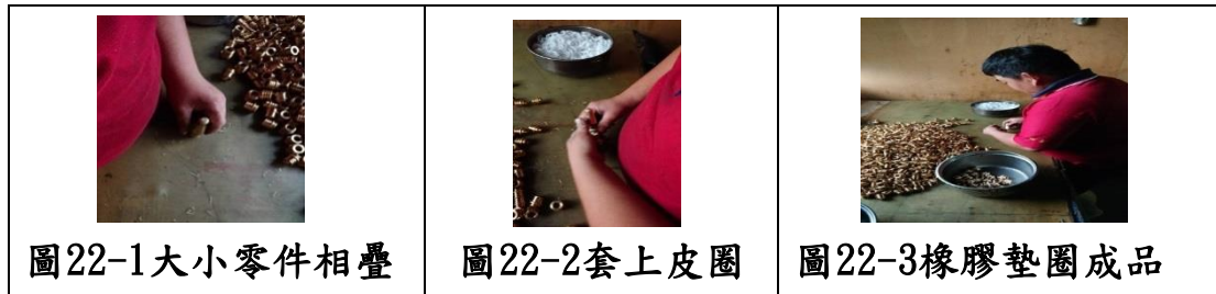
圖22 橡膠墊圈套設過程
