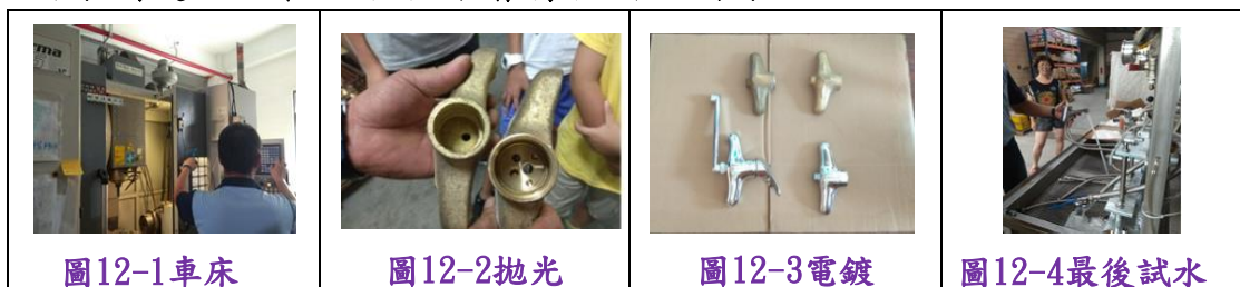
圖12謝明隆老闆示範製水龍頭流程
