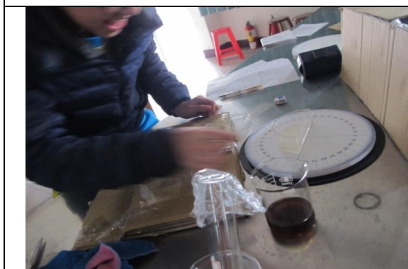
照射半圓形水槽的的反射光調整入射角
