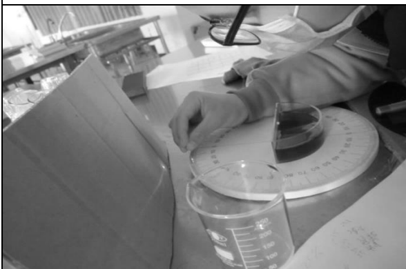
以紅色雷射筆照射黑糖糖水以測量折射角
