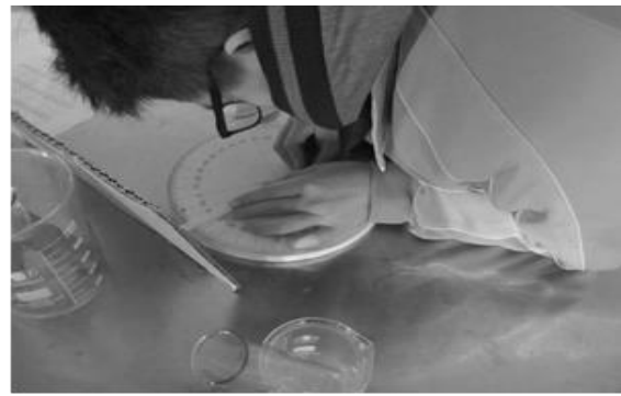
用尺輔助對準圓心測量折射角
