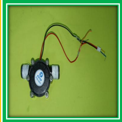
↑ 圖 17-3 水車式發電機
