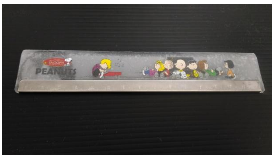
圖 51：PMMA 直尺表面霧化
