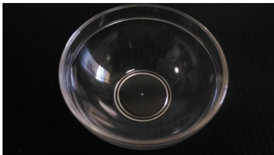
圖 57：PMMA 敷臉碗未出現裂痕
