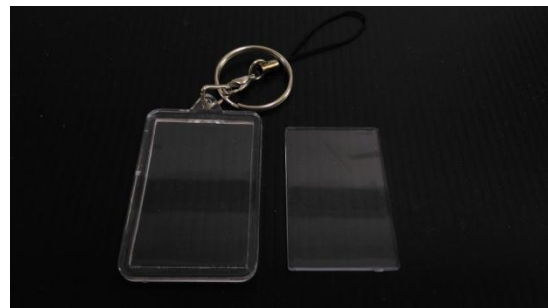
圖 58：PMMA 鑰匙圈未出現裂痕
