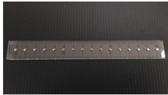
圖 56：PMMA 直尺未出現裂痕
