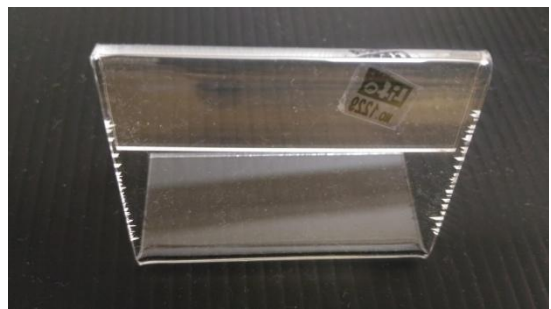
圖 52：PMMA 標示牌邊緣出現直條裂痕
