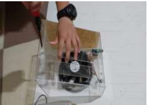
風扇上蓋裝隔離條
