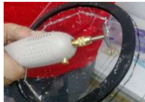
切割風扇吸風的通風孔
