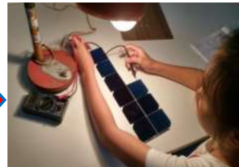
串聯測試電壓及電流
