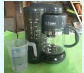
圖6-4 分別將草木灰倒入美式咖啡機的濾紙中，以200 g蒸餾水進行滴漏
