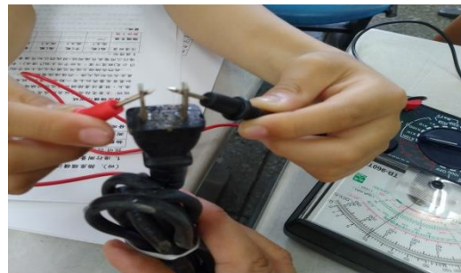
圖 28. 測量積汗潮濕插座頭電阻 值
