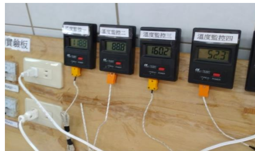
圖 35.導線測試達 118、88、160°C
