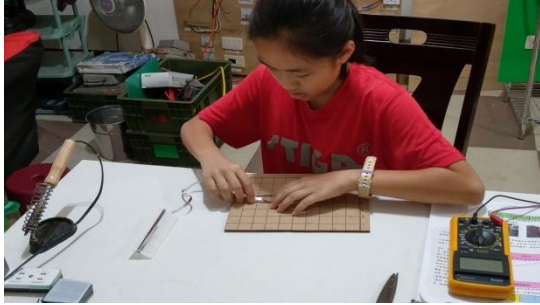
圖 24 先接出兩極(正負極端)
