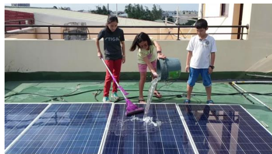
圖 33. 3 分鐘後潑水降溫測試紀錄
