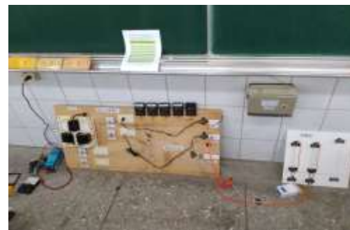
整體測試情形，左側為變壓區，中間為測試區，右側為負載區
