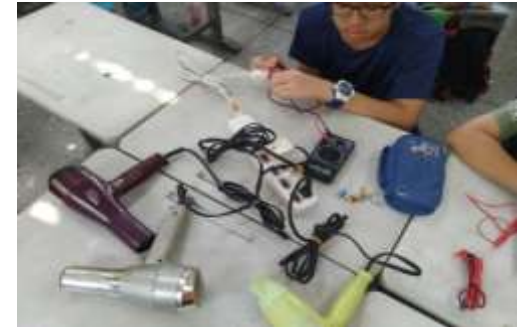
吹髮機並聯測量情形
