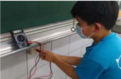
測量插座內電壓116V
