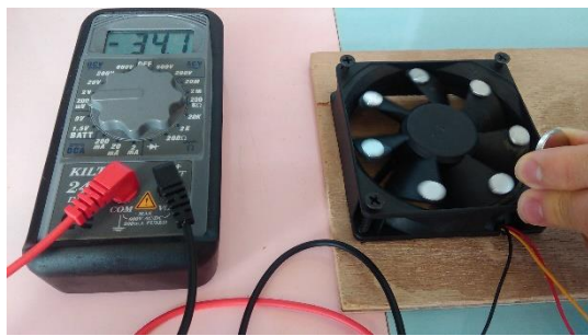
圖十二：磁力發電實驗裝置圖(旋轉錄影中截取畫面)
