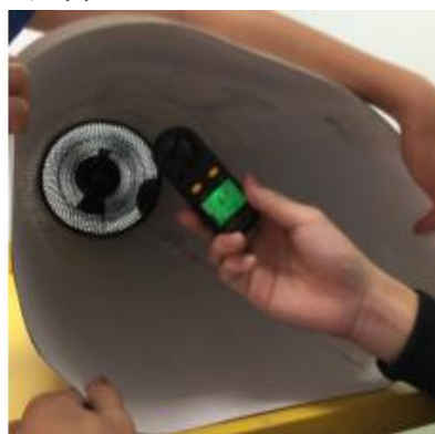
圖 14 120cm 導風管出風口的風速量測
