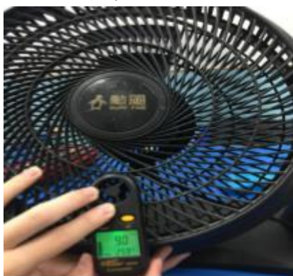
圖 13 原動扇的風速量測
