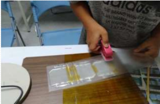
在標示正負極處打洞
