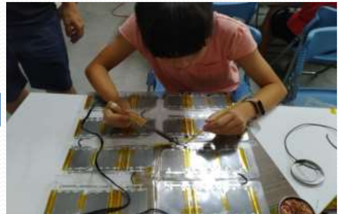
打洞處進入串接與二極體焊接
