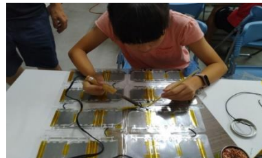
圖 42 打洞處進入串接與二極體焊接
