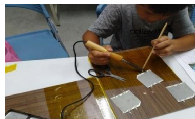
圖 36 將晶片兩極使用焊帶焊接引出
