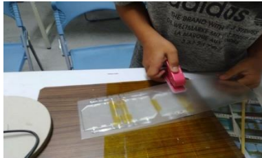
圖 39 在標示正負極處打洞
