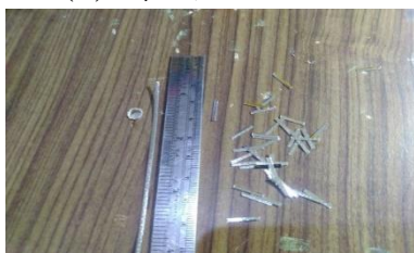
圖 35 將焊線剪成約 10MM 長度
