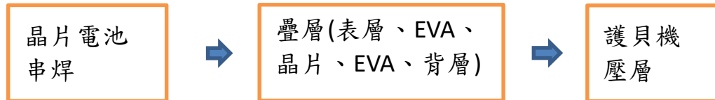
自組太陽能模組封裝流程(表 13):(疊層使用護貝膜，護貝機做壓層)
