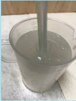
圖 33-1 海藻酸鈉水溶液中插入一粗一細吸管
