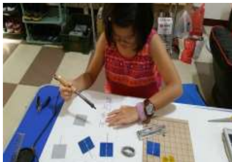
將串接線焊於晶片上
